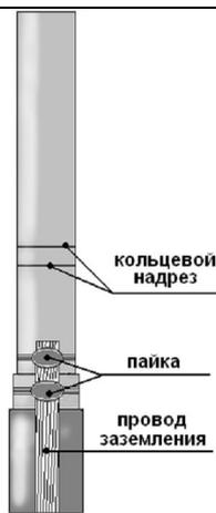
2. Смонтируйте на лентах брони и на оболочке заземляющий провод. Обезжирьте оболочку кабеля.
